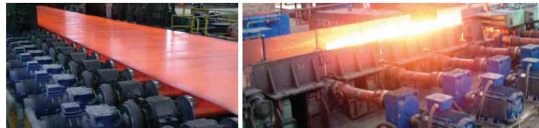
Металлургия, привода рольганговой группы для тонколистового проката.
