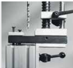
Сквозное и резьбовое отверстия для комплекта стандартных креплений
