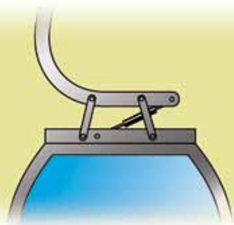
Раскачивание, амортизируемое гидравлическим демпфером
